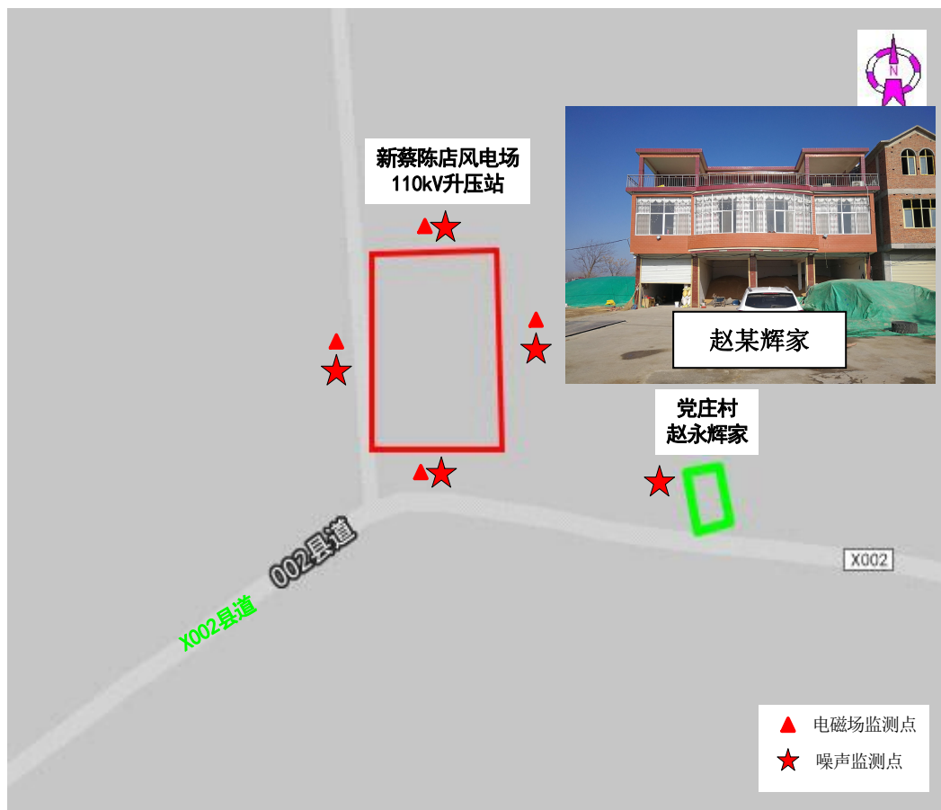
图4 风电场 110kV 升压站监测布点图
